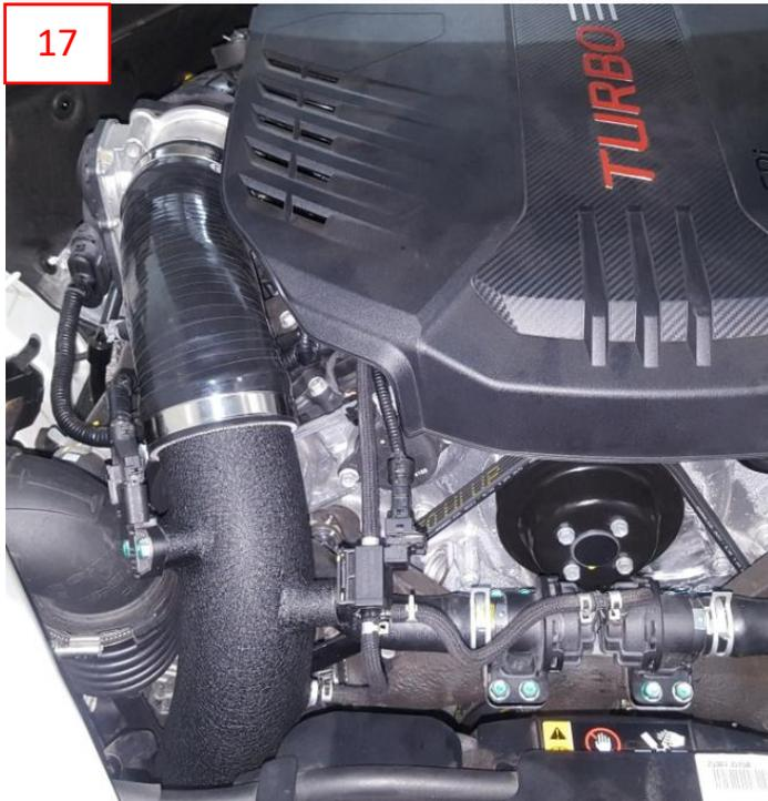
Stellen Sie sicher, dass die WT - Komponenten keinen unsachgemäßen Kontakt zu umliegenden Bauteilen haben.
